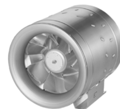
630 мм 710 мм EL 630 EC 01 ID 119322 EL 710 EC 01 ID 119359 400V 3~/50Hz 50 °C 15100 m³/h 2.250 W 3,8 A 88/90/81 db(A) 400V 3~/50Hz 80 °C 20200 m³/h 3.100 W 5,7 A 88/92/80 db(A) Вентиляторы ETALINE с электродвигателями ЕС должны быть подключены к контроллерам (см. дополнительные принадлежности).
