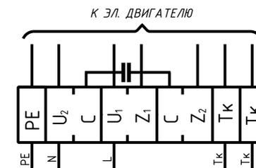
**Схема 3.** Подключение двигателя вентилятора RL 90-50-4D к электросети.
