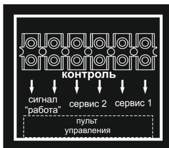
**Рисунок 27 - Клеммная колодка подключения системы индикации**
