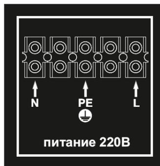
**Рисунок 25 - Клеммная колодка подключения питания**
