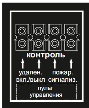
**Рисунок 26 - Клеммная колодка удаленного управления**
