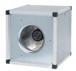
**Регулирование скорости**: Управление электродвигателем осуществляется с помощью сигнала 0-10 В. Электродвигатели вентиляторов типоразмеров выше 450 управляются сигналом 10 или 20 В через внешний потенциометр. Все вентиляторы оснащены устройством аварийной сигнализации, подключаемым через сухой контакт. Питание электродвигателей от сети 50 или 60 Гц. Напряжение питания однофазных электродвигателей может изменяться от 200 до 277 В, трехфазных - от 380 до 480 В.
