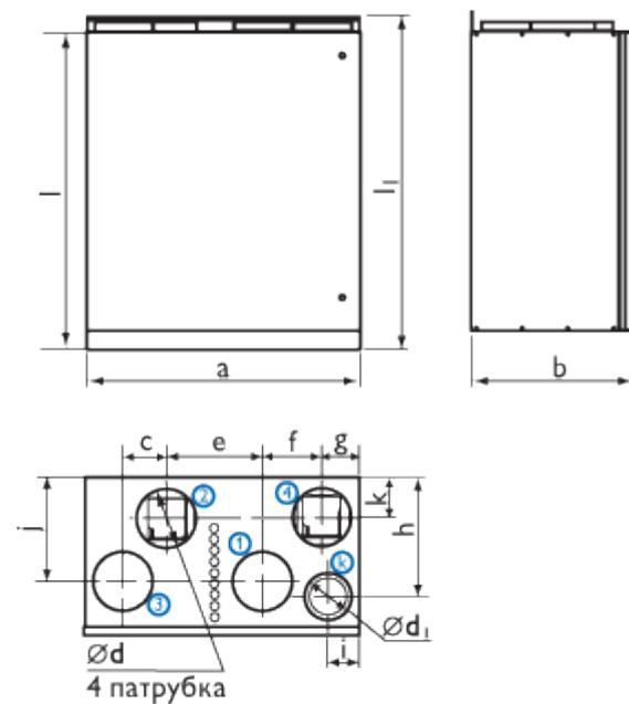
1 - Наружный воздух; 2 - Подаваемый воздух; 3 - Удаляемый воздух; 4 - Выбрасываемый воздух; k-Кухонная вытяжка
