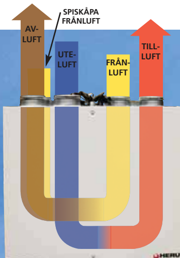
HERU® 70T/100 T EC/160 T EC går att beställa i höger- eller vänsterutförande, och med eller utan anslutning till spiskåpa.
