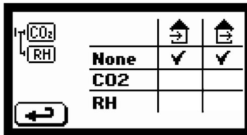
То устройство будет игнорировать подключенный датчик.
