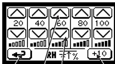
Настройка зависимости оборотов вентилятора от относительной влажности воздуха. Эта настройка имеет значение лишь в том случае, если устройство оснащено датчиком относительной влажности и этот датчик активен - раздел 2.6-10 Относительная влажность указывается в %. После превышения установленной величины относительной влажности устройство переключится на более высокую степень оборотов. При падении величины относительной влажности устройство переключится на более низкую степень оборотов.
