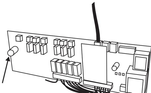
Тип предохранителя: T 50mA / 250 V, размер: 5 x 20
